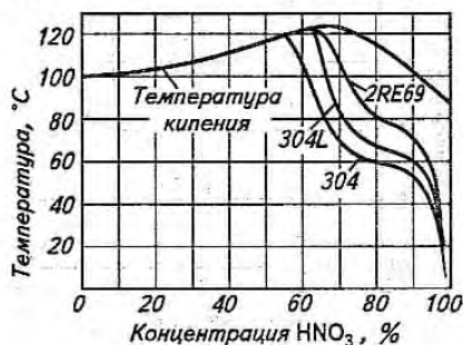
Рис. 33.7. Линии постоянной скорости коррозии (0,1 мм/год) хромоникелевых сталей 304 (типа 08X18H10T), 304L (типа 03X18H11) [13] и 2RE69 (02X25H22AM2) [данные Sandvik Steel] в азотной кислоте
